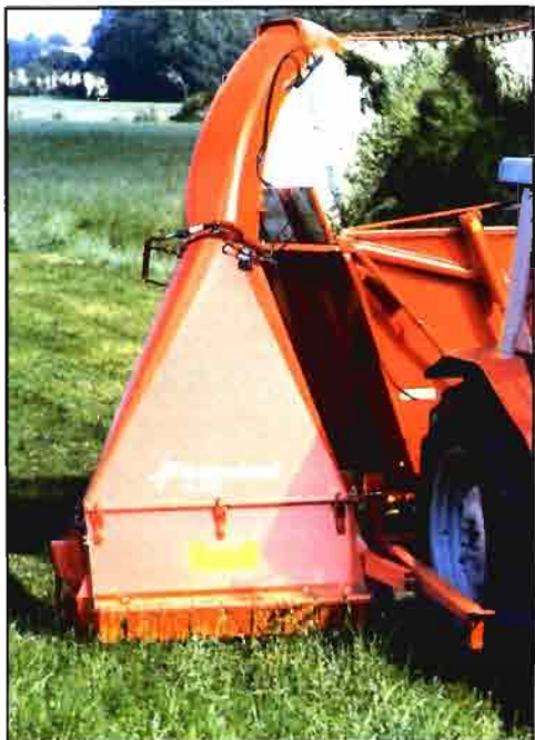
Fig. 1 (foto izquierda): Picadora de mayales. Fig. 2 (foto abajo): Rotor de mayales.
