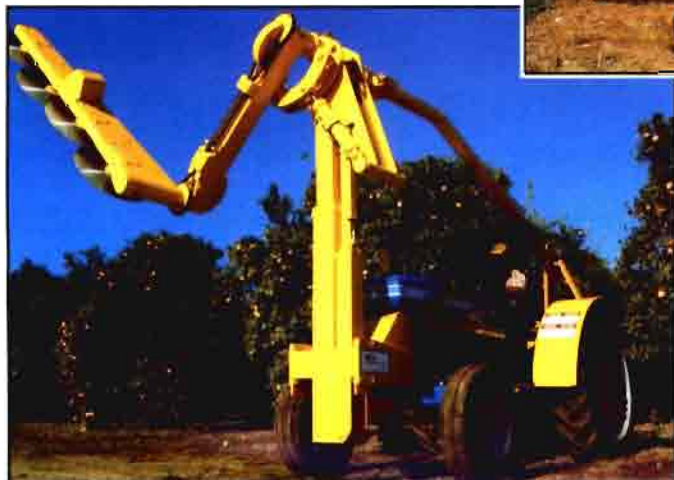
Prepodadora de frutales. Arriba, plataforma auxiliar para poda o cosecha.
