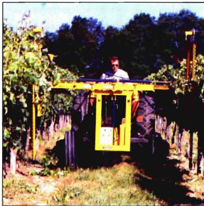
Máquina despuntadora de viñas de Pellenc, con cuchillas alternativas rectas.
