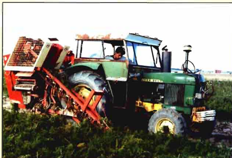
Máquina para recolectar zanahorias, arrancándolas del suelo.
