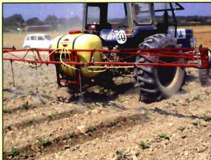
Tratamiento fitosanitario en banda y localizado, utilizando droplets.
