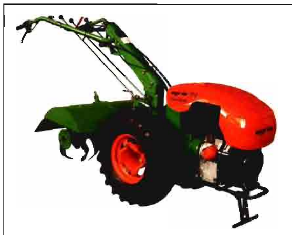
Motocultor Global de Agria, con múltiples aplicaciones. Motor diesel, de 1 ó 2 cilindros y de 482 a 654 c.c., según modelos.
