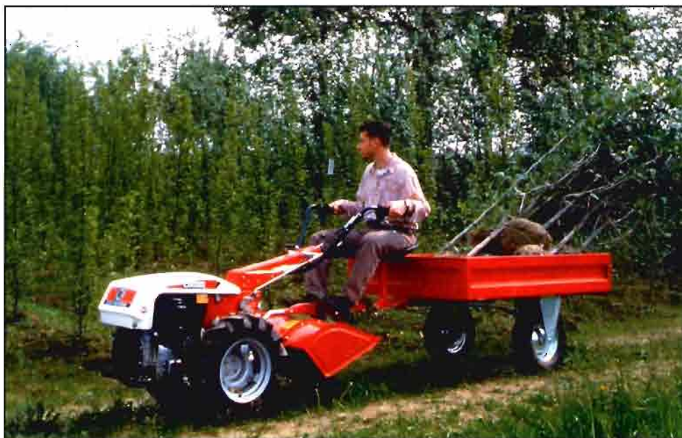
El Carraro 751 E es el motocultor más potente de la gama de Antonio Carraro, con 14 CV de potencia.
