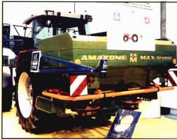
Nueva abonadora de Amazone, cuyos sensores miden la intensidad del verde del cultivo para modular el aporte del nitrógeno. Dcha. La cosechadora Lexion de Claas, equipada con control GPS y ordenador de a bordo.
