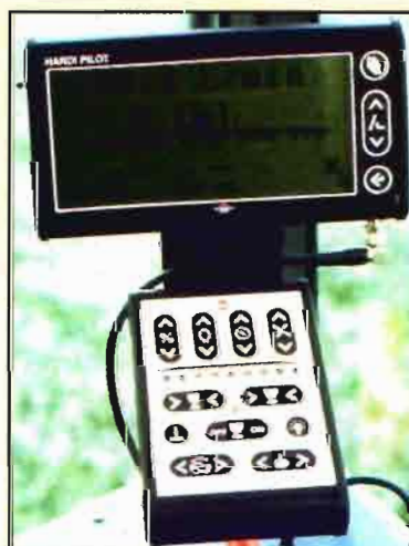
Ejemplo de aplicación de herbicida basado en mapa de parcela realizado gracias al ordenador Hardi Pilot con Fieldstar DGPS en el pulverizador.
