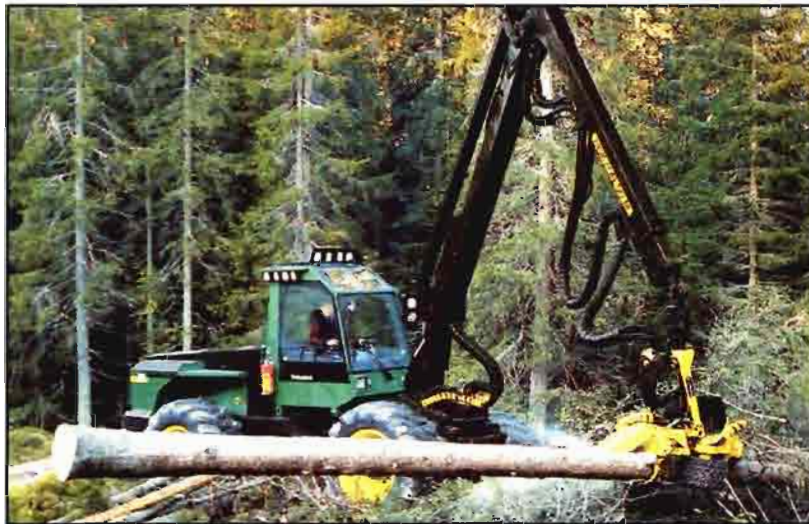
El cabezal de la cosechadora de garra puede hacer el apeo, desramado y tronzado de la madera.
