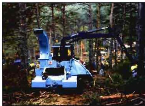
Astilladora móvil para limpieza de la zona de corta.
