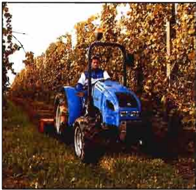
Fig. 6- Tractor provisto de arco de protección delantero abatible.
