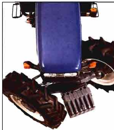
Fig. 9- Eje delantero que gira para facilitar la dirección en lugares estrechos (tractores TNF de New Holland).
