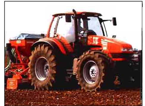
Fig. 8- Tractor provisto de suspensión hidráulica en el eje delantero y neumática en la cabina.
