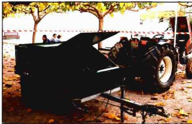
En menos de una hora, este banco puede detectar distintos fallos en el motor.
