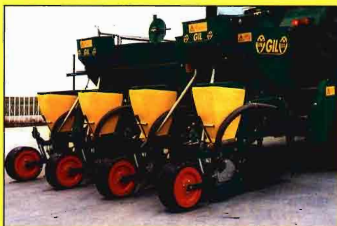
Sembradora monograno neumática de precisión, para maíz, girasol, remolacha, etc.
