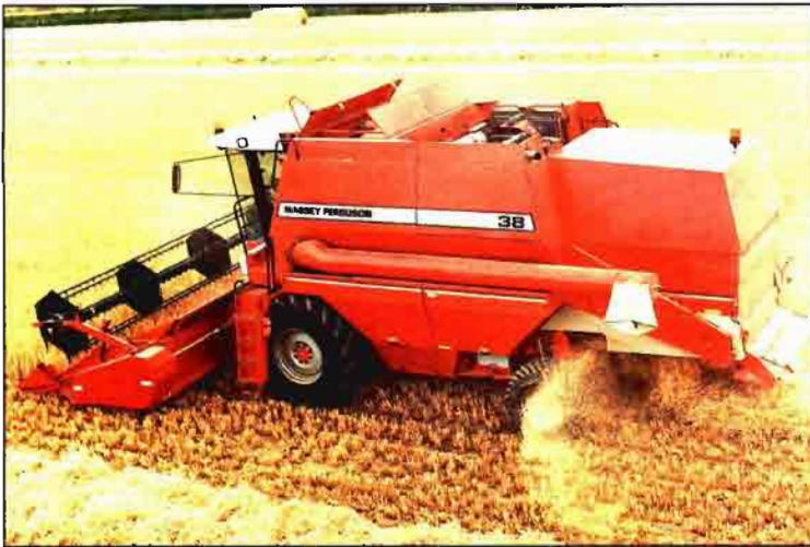
Las cosechadoras envían toda la información sobre el volumen cosechado al DGPS mientras efectúan su labor para elaborar un mapa que luego se usa al preparar el suelo.
