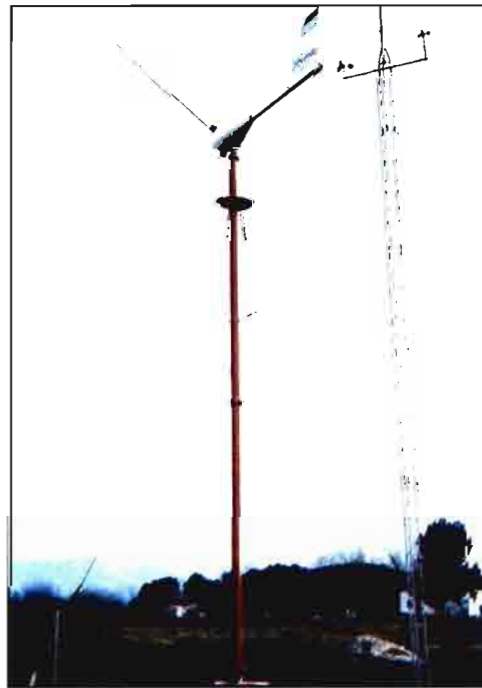
Fig. 7.- Aerogenerador de 12 kW fabricado por Juan y David Bornay.
