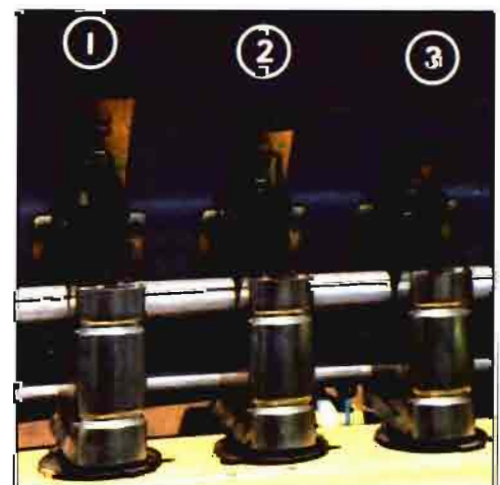
Foto 5. Colocación de las trampillas. 1) Para cereales y granos gruesos. 2) Para semillas pequeñas. 3) Posición cerrada. (Doc. Sulky).
