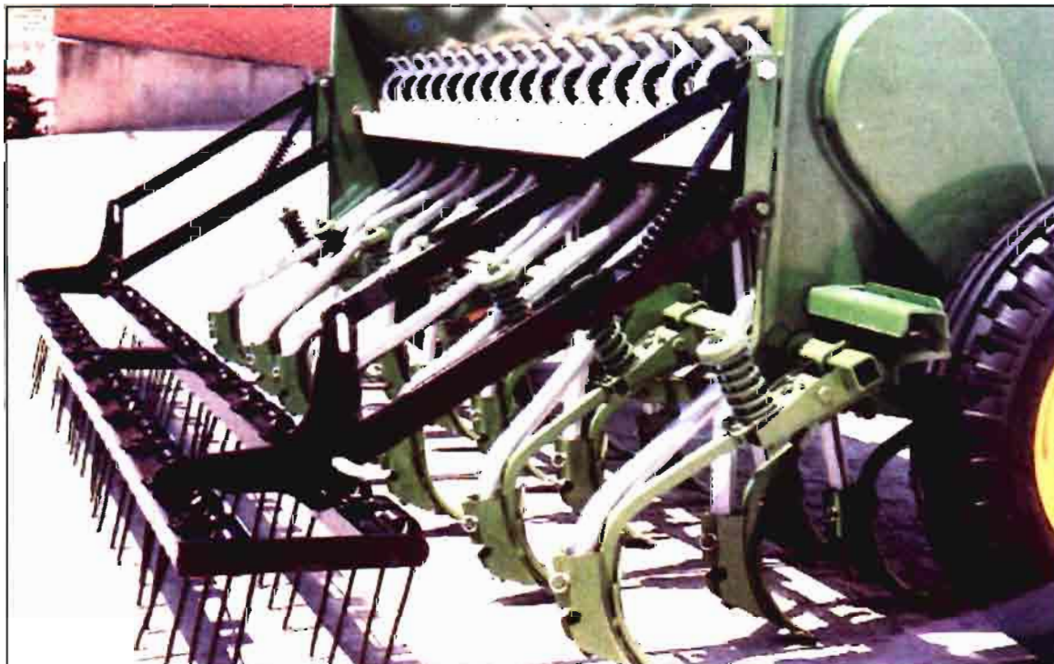
Foto 9. Brazo de siembra con resorte de regulación de la presión sobre el suelo. (Doc. Gil).
