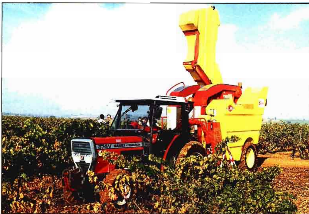
Máquinas arrastradas y accionadas hidráulicamente por tractores viñeros representan una opción interesante para fincas pequeñas o medianas. En la foto el modelo Alma TX.
