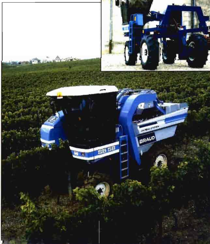
La imagen de las vendimiadoras será cada vez más frecuente. En este caso, la Braud New Holland modelo SB58, con motor turbo alimentado, de 108 CV.
