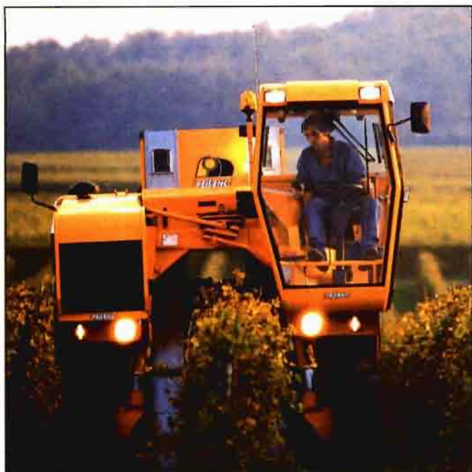
La oferta de distintas marcas y modelos es ya considerable. Modelo 3140 de Pellenc en el que podemos ver el sistema hidráulico de adaptación a la pendiente.
