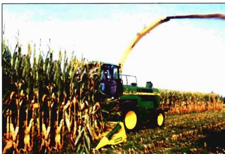
Picadora automotriz John Deere 6950 con una potencia máxima de 540 CV.
