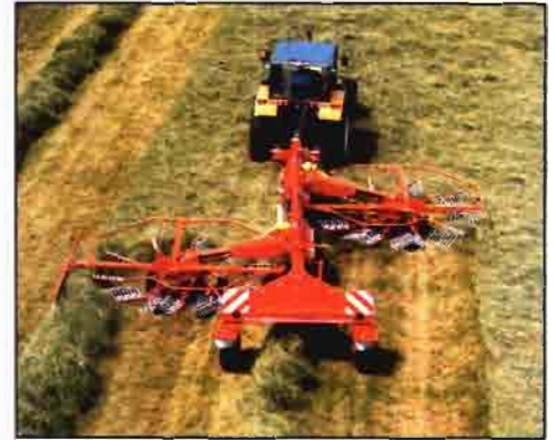
Hilerador Kuhn GA 7302 DL que puede realizar hileras simples o dobles.
