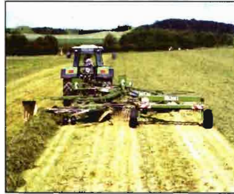
Hileradora Krone K5 6.80-13. Podemos apreciar la considerable anchura agrupada en una hilera.
