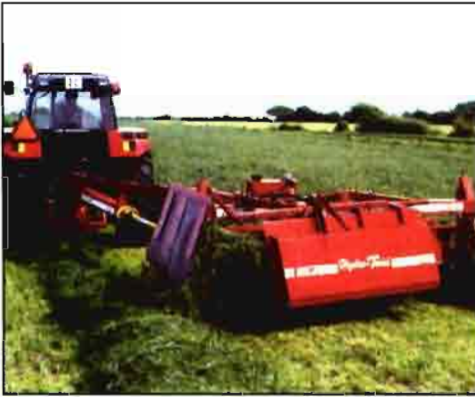
Acondicionadora HydroTwin de JF de descarga lateral, acoplable a diversos modelos de segadora.
