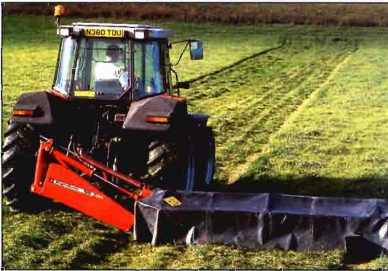
Segadora MF 109 de Massey Ferguson, con una anchura de corte de 2,79 m.
