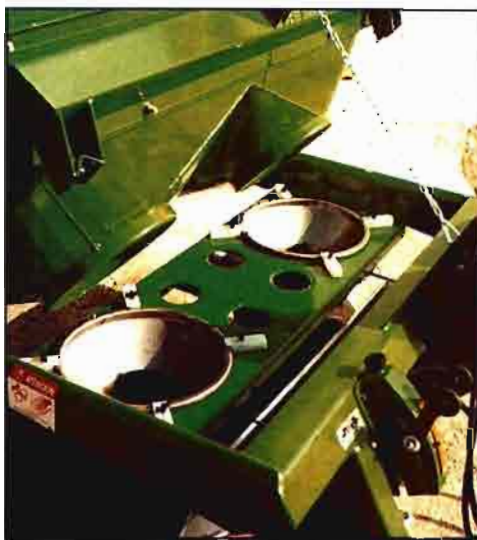
La tolva basculante facilita la limpieza del sistema de distribución o el cambio de discos. En la foto abonadora centrífuga de doble disco de Julio Gil.
