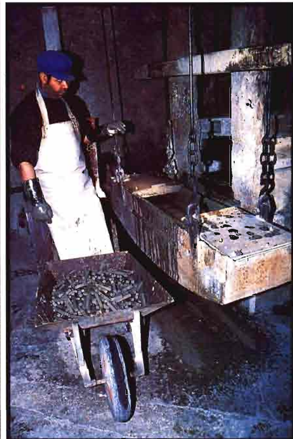
Tres fases del proceso de fabricación de las piedras de afilar: A la izquierda, Sylvain corta las losas de gres a la medida y forma definitiva. En el centro, con el «tranchet» da el espesor definitivo a cada pieza. A la derecha, con el movimiento del balancín las piedras se pulen en un baño abrasivo de agua, arena y sílice
