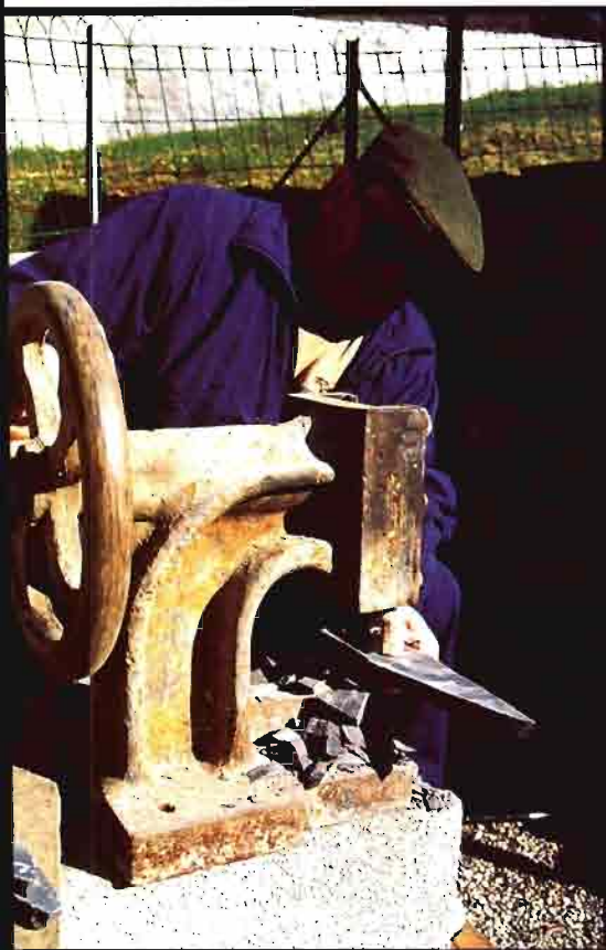
Tres fases del proceso de fabricación de las piedras de afilar: A la izquierda, Sylvain corta las losas de gres a la medida y forma definitiva. En el centro, con el «tranchet» da el espesor definitivo a cada pieza. A la derecha, con el movimiento del balancín las piedras se pulen en un baño abrasivo de agua, arena y sílice
