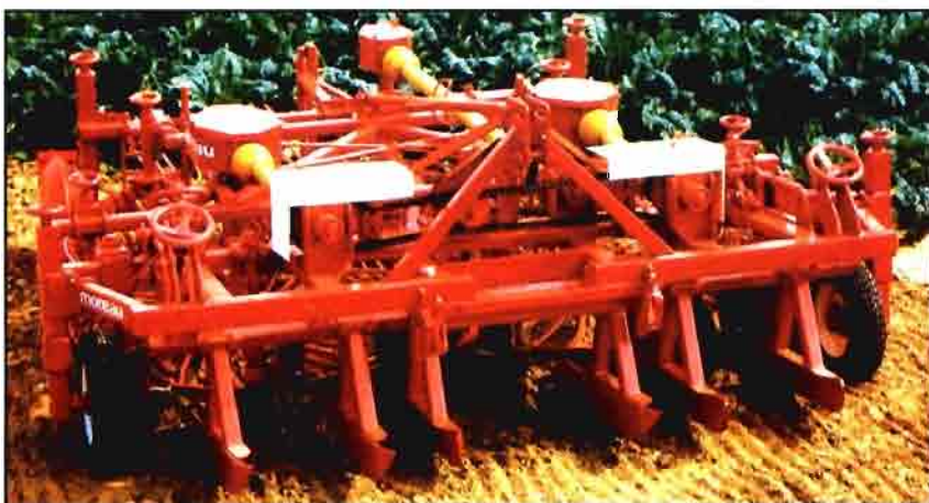
A la izquierda, arrancadora-limpiadora-allineadora, eslabón anterior de la cadena de recolección. En la imagen de la derecha, equipo completo.
