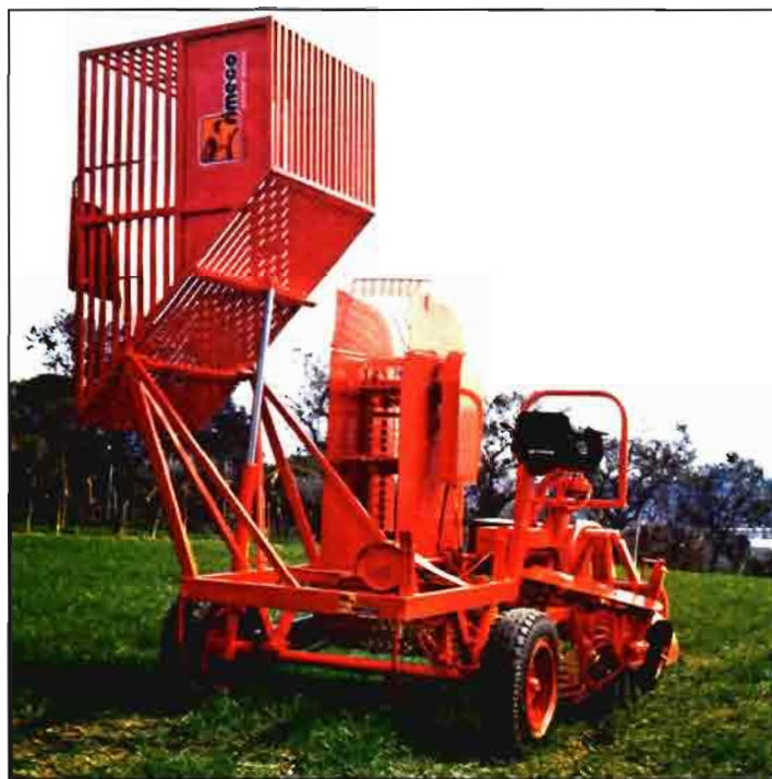
La altura de descarga es un detalle importante a tener en cuenta en el momento de elegir el equipo de recolección de remolacha.
