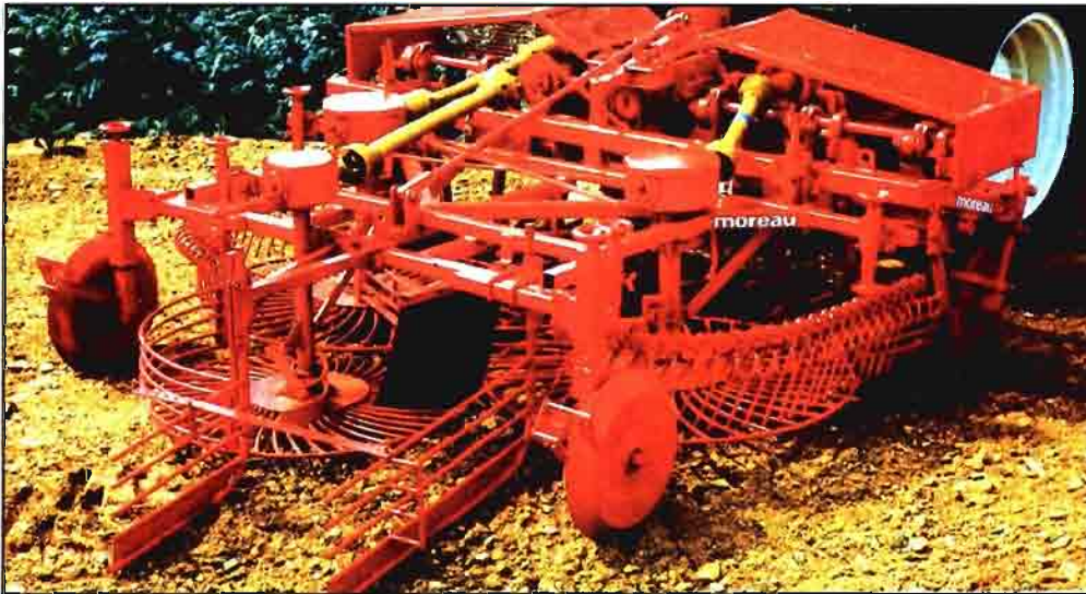
Dentro de las posibilidades de recolección por equipos descompuestos tenemos máquinas arrastradas recogedoras-limpiadoras-cargadoras.
