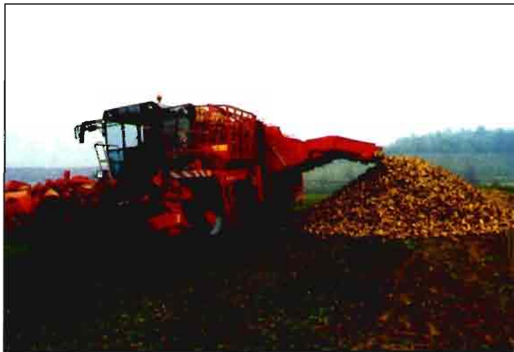
Ejemplo de máquina cosechadora integral, automotriz, de 6 hileras.
