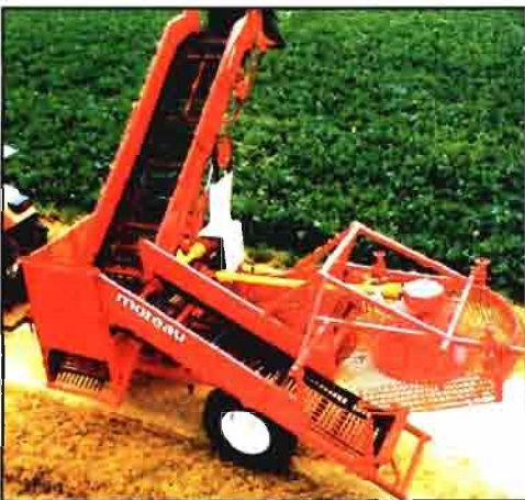
Dentro de las posibilidades de recolección por equipos descompuestos tenemos máquinas arrastradas recogedoras-limpiadoras-cargadoras.
