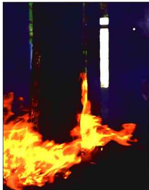
Ensayo con hojarasca y tronco de Pinus Pinaster que muestra paso a paso la progresión del fuego alrededor del tronco y el aspecto de los residuos y del tronco al final.
