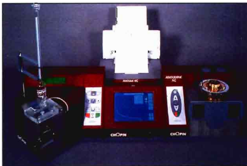
El Alveógrafo de Chopin se usa para discernir la calidad pastificadora del trigo duro.
