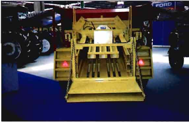
Vista posterior del canal de compresión de una macroempacadora.
