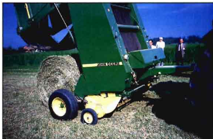
Rotoempacadora de cámara variable en la fase de descarga.
