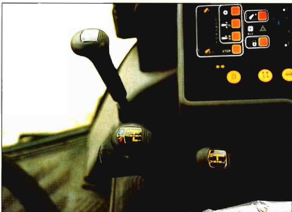
Palanca de mando de un doble Hi-Lo (Agro-Shift Same).
