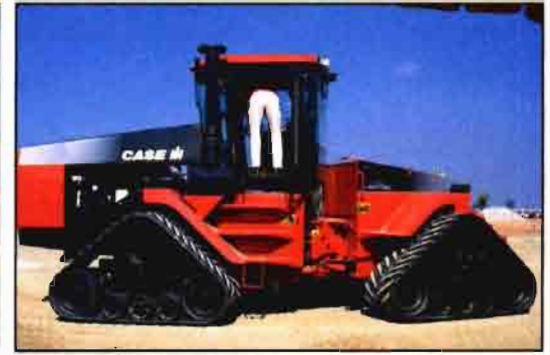
Fig. 6. Tractor Case, modelo Quadtrac, provisto de 4 semiorugas de goma.
