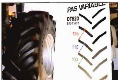
Fig. 8. Neumático agrícola con resaltes, de peso variable.
