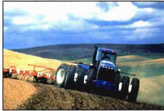
Fig. 5. Tractor New Holland, modelo Versatile de 425 CV, con 12 (4x3) ruedas.
