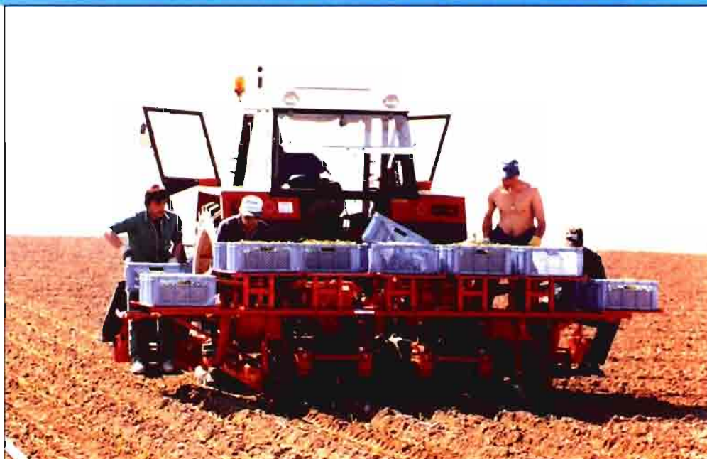
Arriba, máquina trasplantadora en pleno trabajo.
