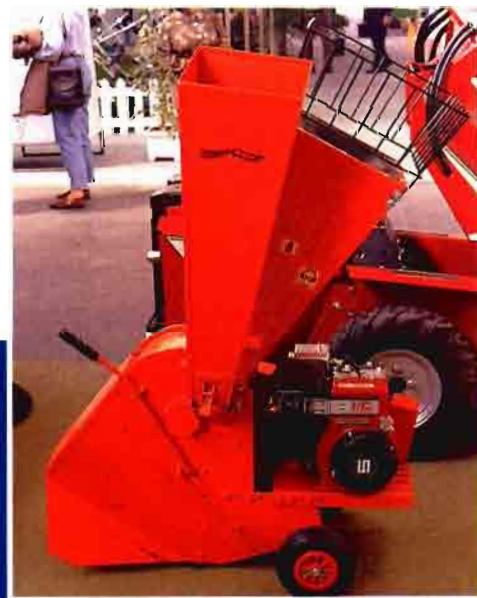
Aspecto típico de una biotrituradora donde se observa el motor térmico, el tubo de alimentación y se advierte el triturado oculto tras la carcasa en la parte inferior.
