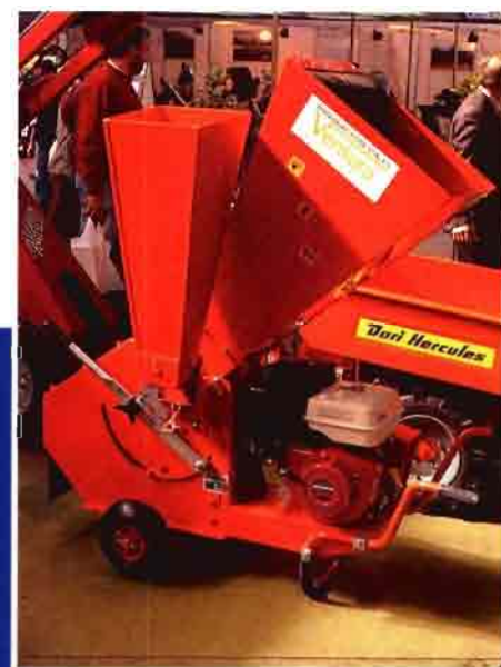
Biotrituradora accionada por un motor térmico, con doble tolva de entrada
