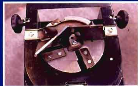
Vista inferior del sistema de corte de una biotrituradora compuesto por 4 cuchillas intercambiables.
