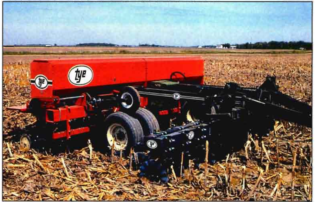
Los discos ondulados para abrir el surco se adaptan perfectamente a la acumulación de residuos.
