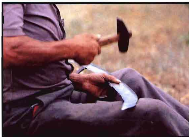
Para «picar el dallo» se utilizaban «els trastes de picar», que eran «a forqueta» y el «martiello».
