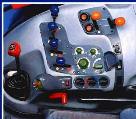
Fig. 8. Lateral derecho de mando en el tractor Agrottron con la palanca de mando Powershift.
