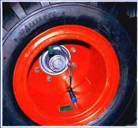
Fig. 13. Dispositivo de inflado de neumáticos desde el puesto de conducción del tractor.
