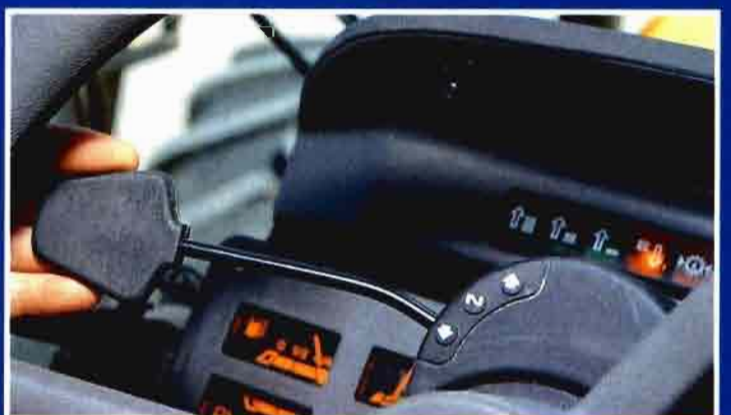
Fig. 6. Inversor automático de la marcha situado a la izquierda del volante de dirección.
