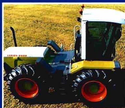
Fig. 2. Tractor Xerion de Claas con la cabina situada hacia atrás.
