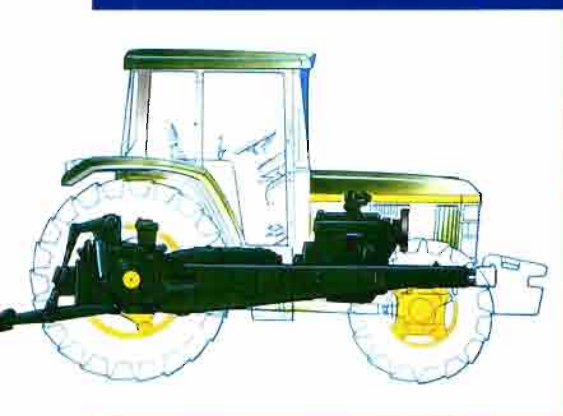
Fig. 1. El bastidor único representa un concepto modular que proporciona una gran flexibilidad en el montaje de equipos en el tractor.
