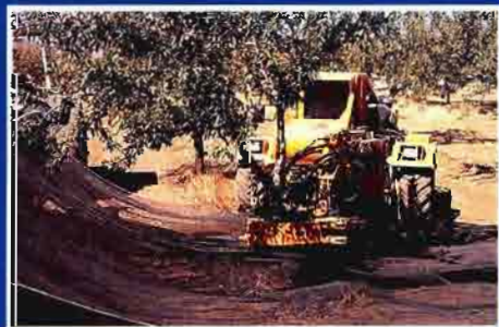
Vibrador autopropulsado Pellenc con una gran maniobrabilidad.
