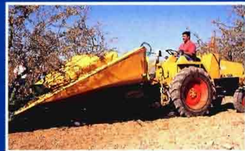
Equipo de recolección de fruta Gascón. El paraguas dispone de unas ruedas de apoyo.
