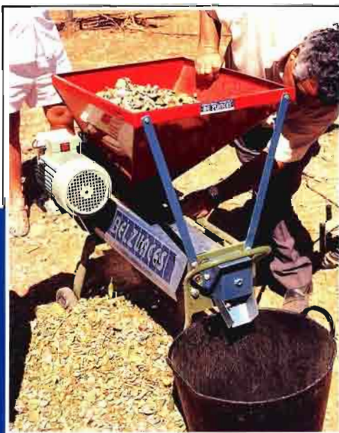
Máquina peladora de almendra Estupiña que participó en la II Demostración.
