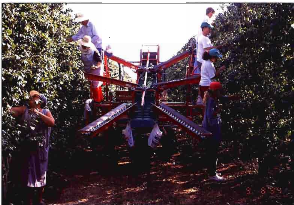
Fig. 11. Plataforma con cintas transportadoras MUCHKHOF.
