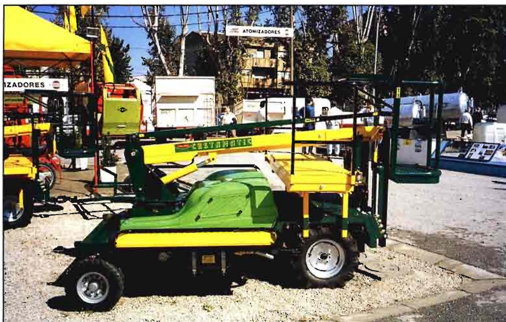
Fig. 8. Equipo CESTAMATIC de Comercial Pujol que dispone de balcones laterales regulables en anchura.
