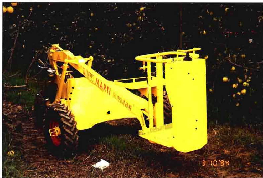
Fig. 1 y 2. La cesta está constituida por un pequeño habitáculo elevable en el que puede ubicarse un solo operario. Cesta Talleres Martí. Esquema de una cesta autopropulsada.
