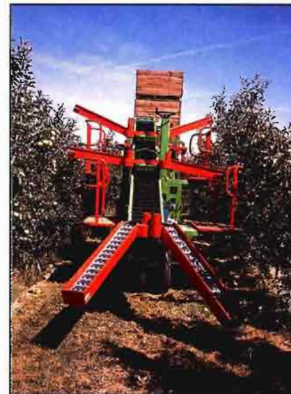
Figs. 3, 4 y 5. Esquema de una plataforma convencional. Algunos fabricantes montan una tercera plataforma en la parte delantera (Plataforma Poli, a la izquierda) y plataforma con cintas transportadoras FRUITAR-JYMPA.
