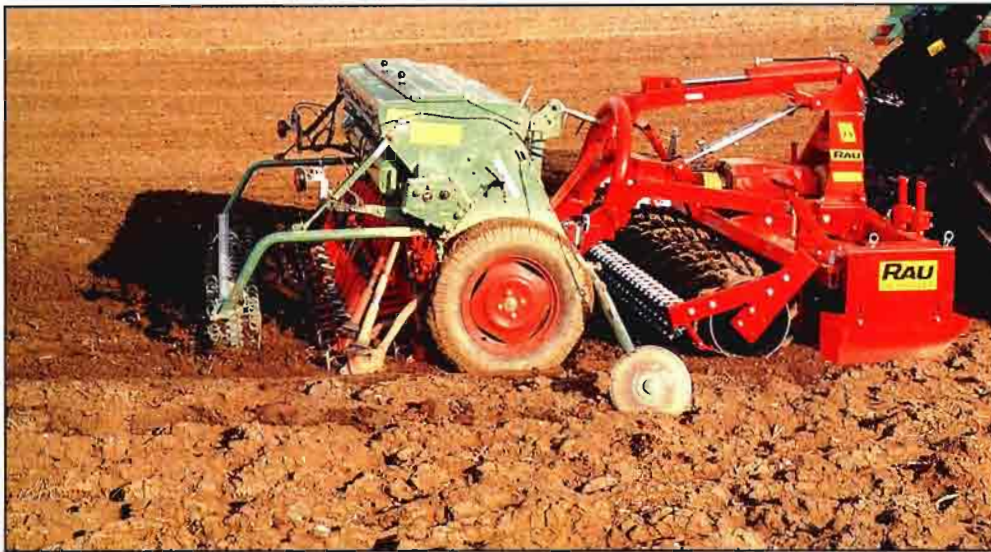
Equipo combinado accionado a la toma de fuerza preparando el terreno y sembrando en un mismo pase (Doc. Rau).
