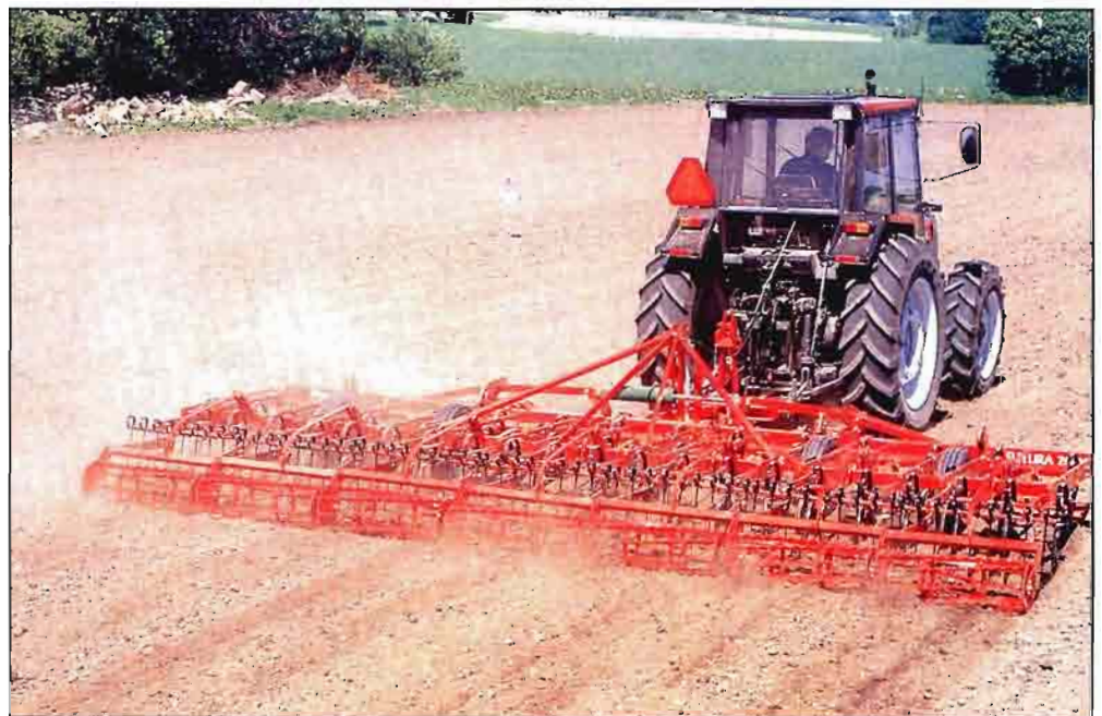
Vibrocultivador preparando el lecho de siembra (Doc. Kverneland).
