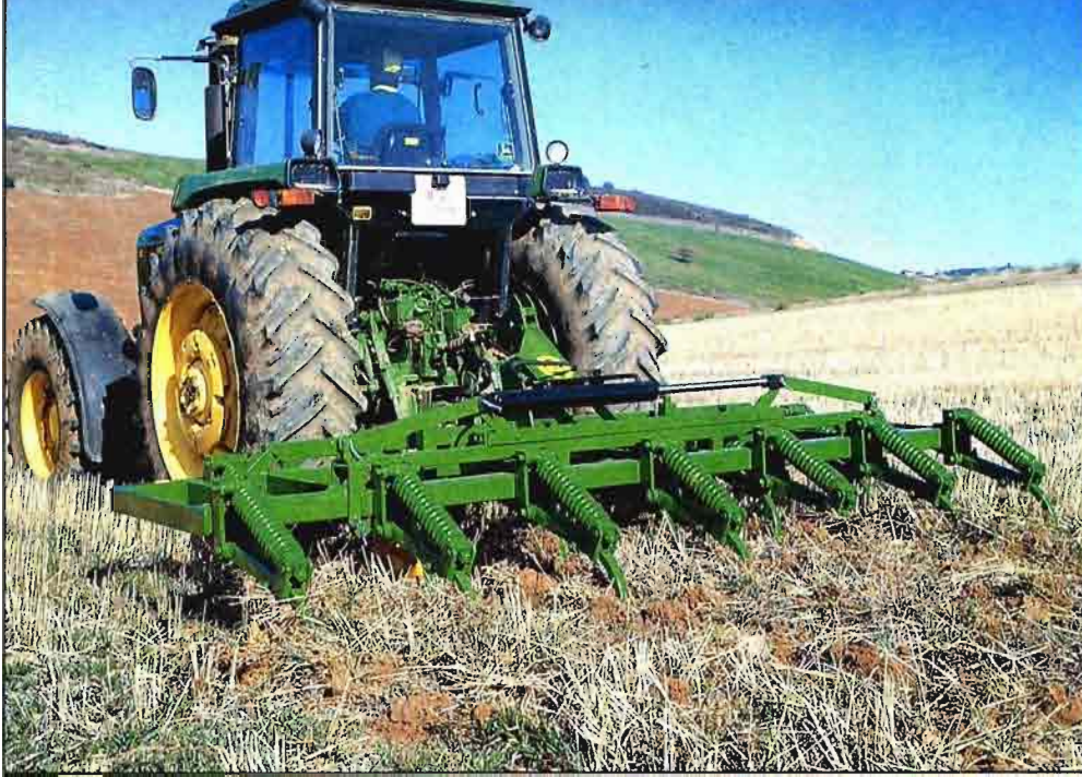
Arado chisel para labores de labranza vertical (Doc. Gil).
