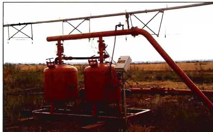
Central de riego que robustece y regula por ordenador, especialmente el riego por goteo del tomate.
