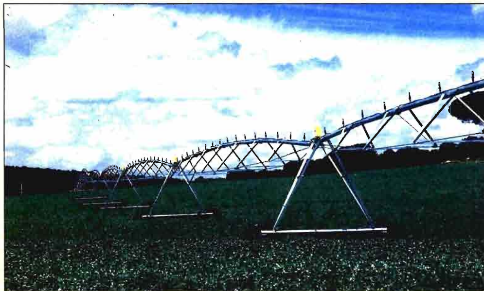
La aspersión mecanizada constituye el sistema más adaptado a las grandes áreas de cultivo extensivo o industrial, permitiendo eficiencias muy elevadas en el empleo del agua.
