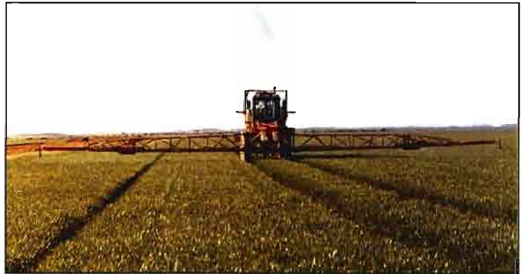
Tareas de pulverización en trigo duro efectuadas por una máquina autopropulsada marca Hardi.
