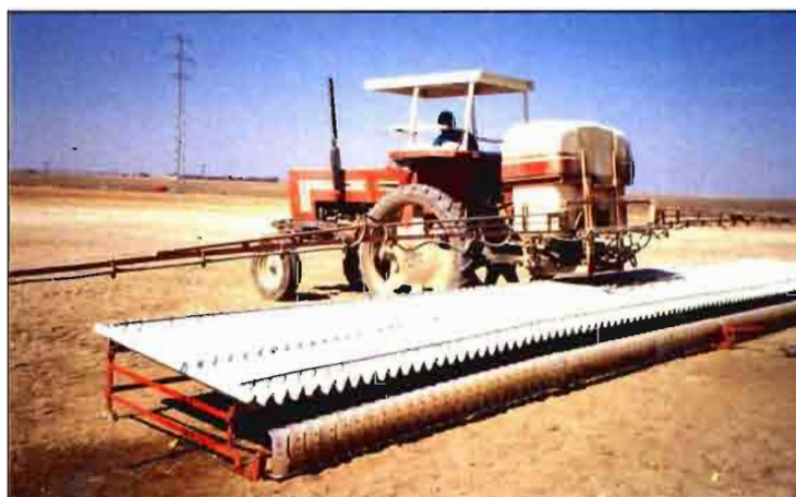
Calibración de un pulverizador en un banco de recogida.
