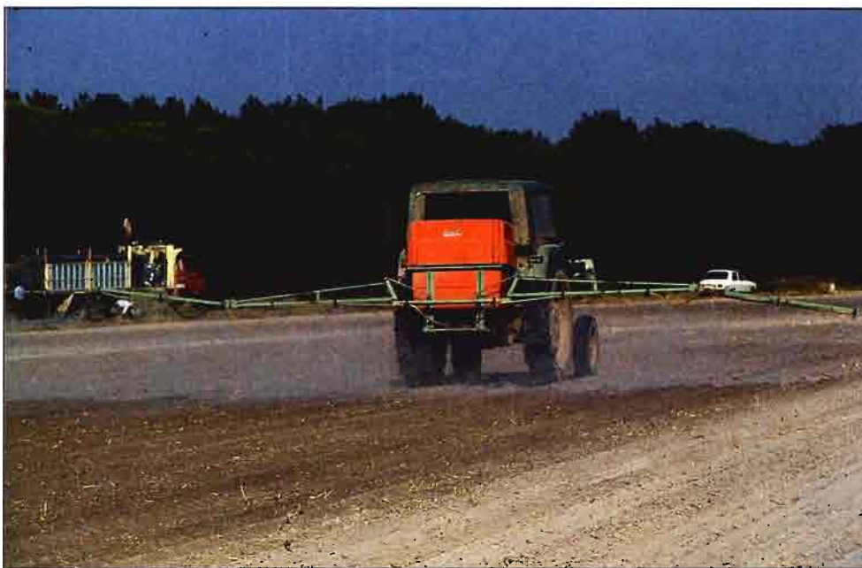
Un equipo con las barras portaboquillas dobladas no asegura una distribución uniforme del herbicida.
