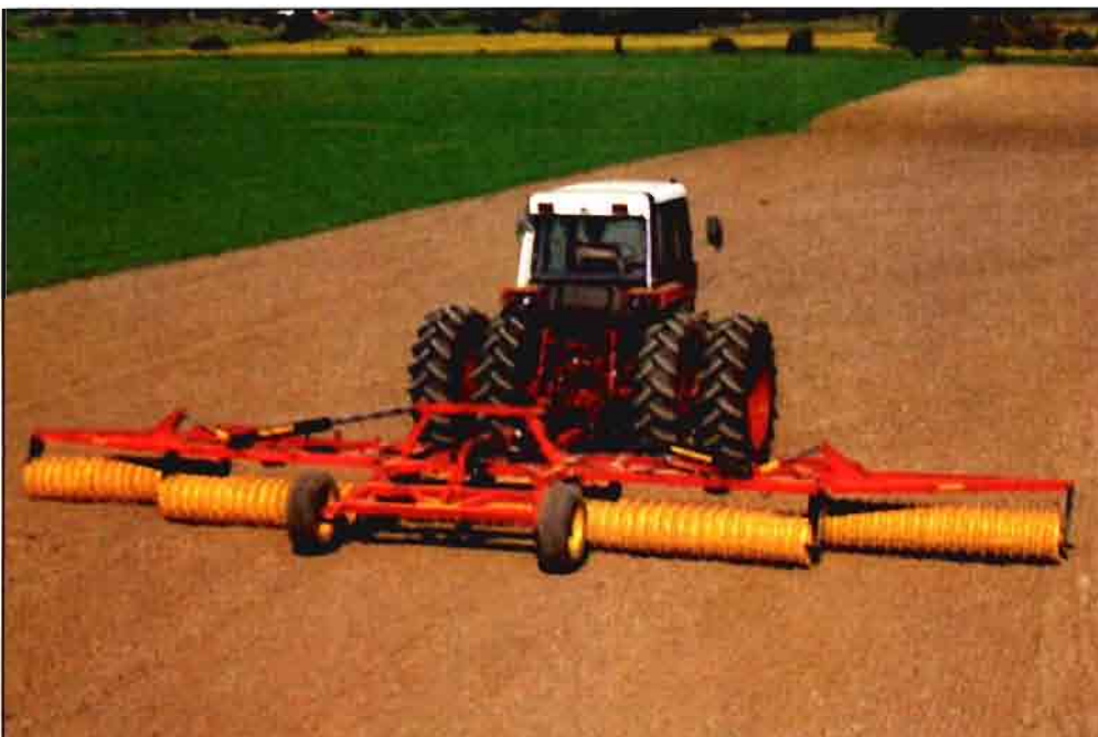
Fig. 5. Rodillo compactador, encargado de reducir los agregados y terrones del suelo.
