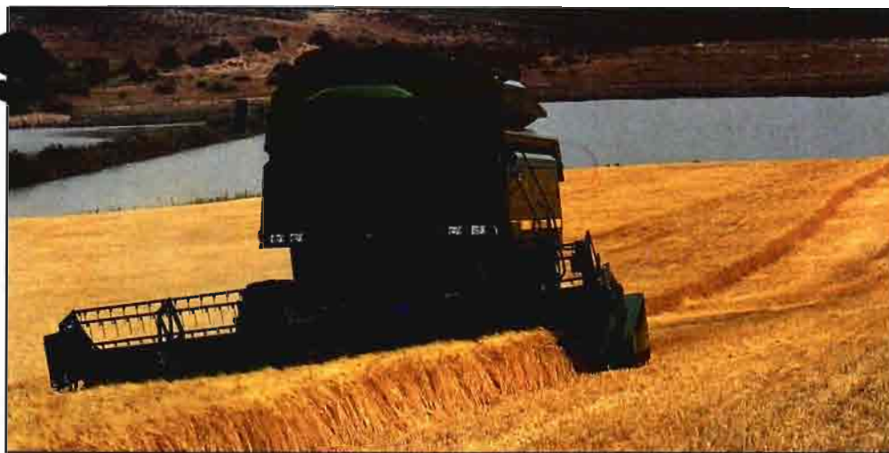
El sistema de nivelación Hillmaster mantiene el batidor de las cosechadoras J. Deere Serie Z, nivelado en pendientes de hasta un 11% de desnivel.
