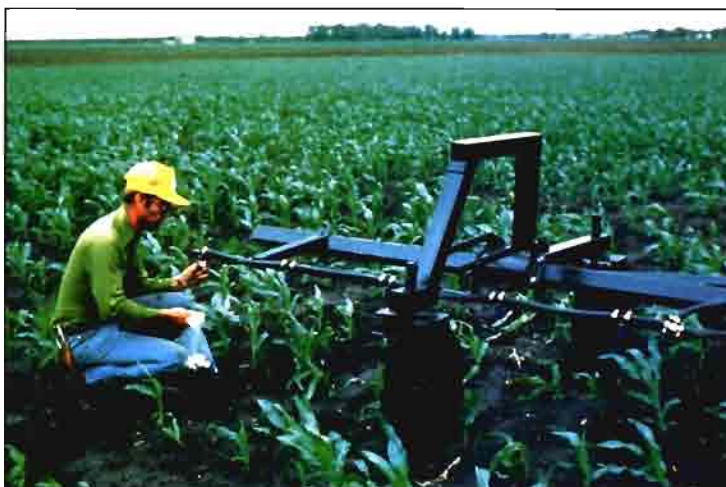
Un control periódico del estado de las boquillas resulta imprescindible.
