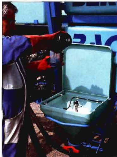
La utilización de mezcladores incorporados asegura la homogeneidad del caldo y mejora la protección del operador.
