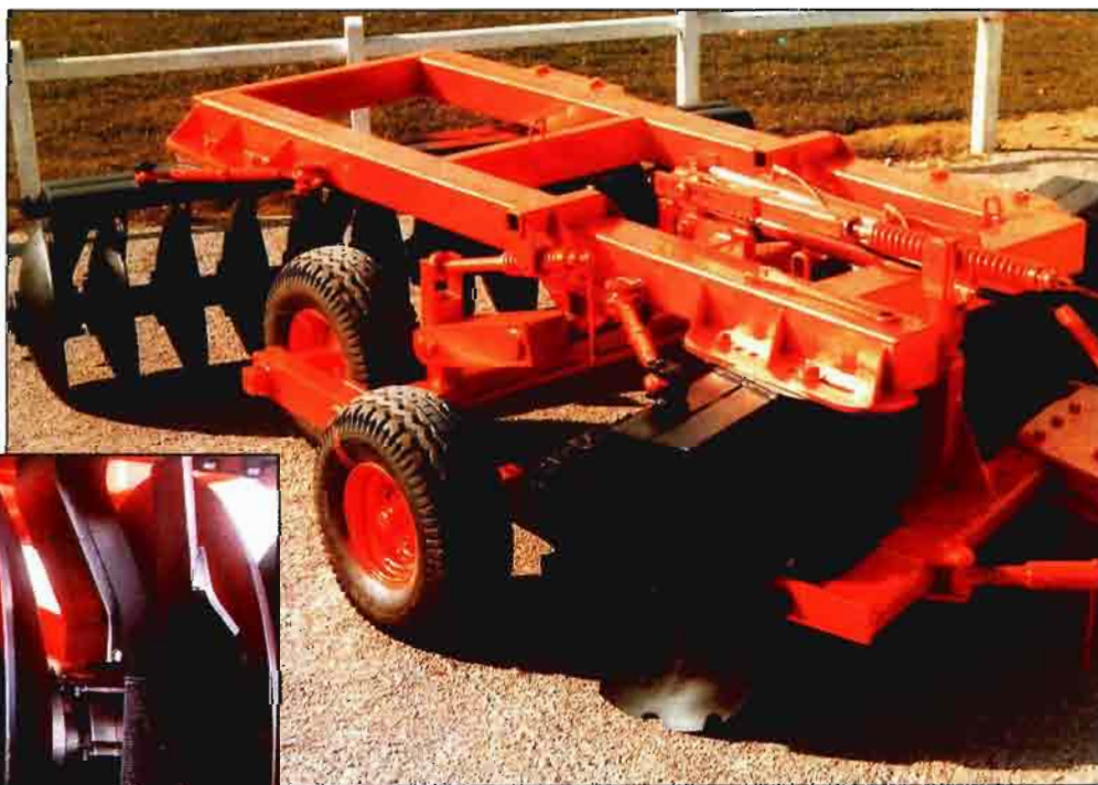
Fig. 1. Disco de grada con raqueta de volteo.
