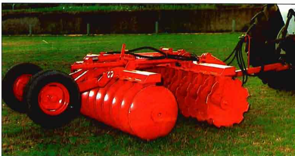
Fig. 3. Cuanto más cerca se encuentran los discos, mayor es el seccionamiento.
