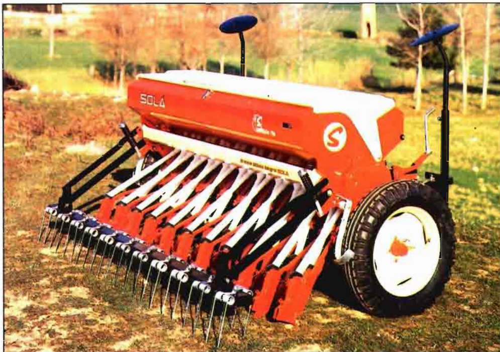
Sembradora de cereales Sola, que incorpora un sistema Integral.
