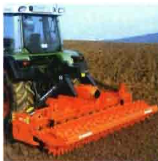
HK32 Hasta 200 HP 3 velocidades con cambio por palanca. En anchos de 3 / 3,5 / 4 m.
