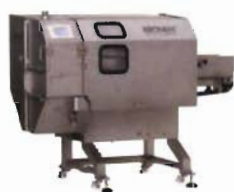
CORTADORA GS30 Para cortar lechugas y cabezas de repollo enteras. Para el corte orientado de productos luengos como: puerros, pepinos, zanahorias, etc.
