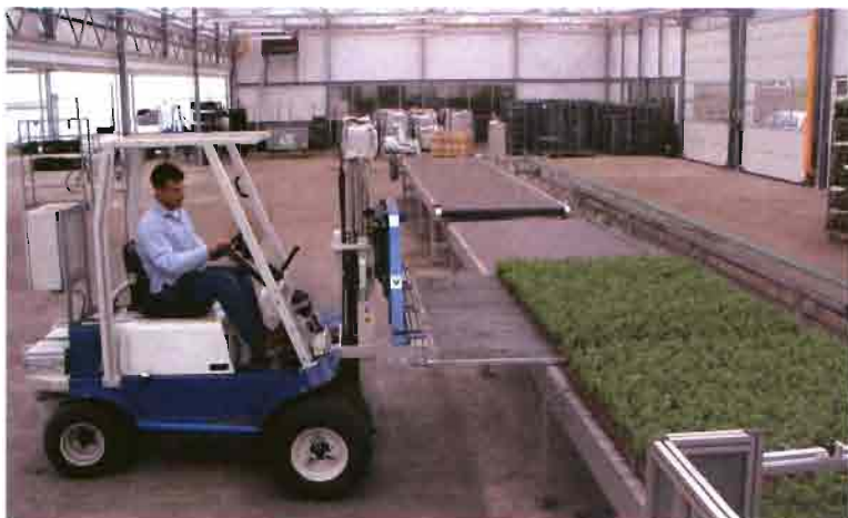
Sistema "Space-O-Mat" retirando las plantas de una cinta.
