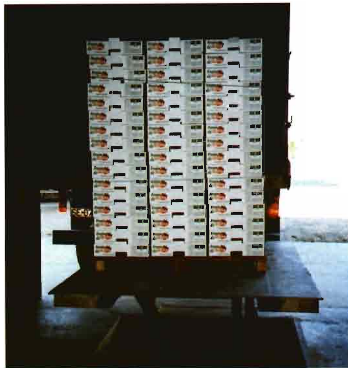
Plataforma hidráulica elevadora de palet a carga camión.
