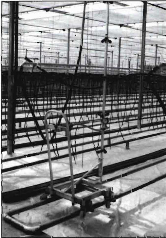
Imagen de un invernadero holandés en Corea, totalmente equipado. En primer plano, carro con tubería y boquillas de riego, para la aplicación de agroquímicos localmente. El sustrato empleado es la lana de vidrio, sobre un sistema de banquetas que permiten la recirculación del agua.
