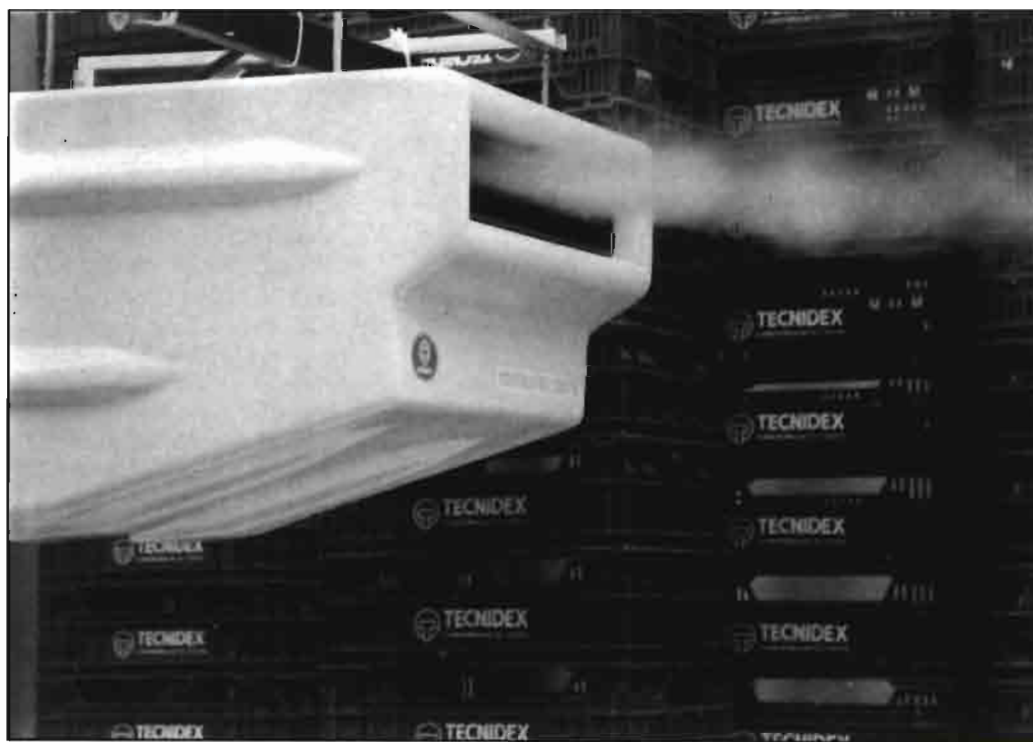
Imagen del sistema Control Tec 2001H, un sistema de humidificación por ultrasonidos que produce gotas uniformes con un tamaño de 4 micrómetros a temperatura ambiente. Las gotas se evaporan rápidamente, subiendo la humedad de la cámara sin mojar los contenidos.
