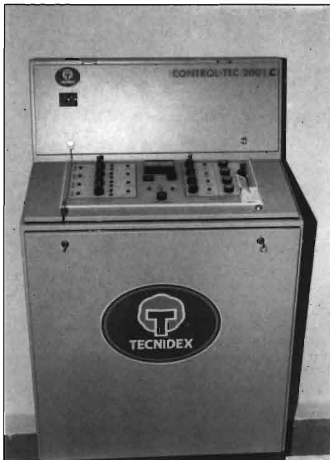
El Control Tec 2001C está programado para inducir la desverdización de cítricos usando la mínima dosis de etileno durante el mínimo tiempo. El sistema controla la concentración de etileno para mantener el nivel óptimo, y está programado para responder a pérdidas de etileno de la cámaras, abriendo o cerrando las electroválvulas de gas según la necesidad
