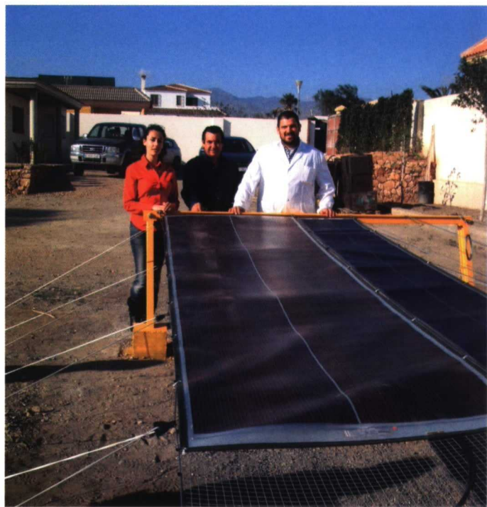
La estructura muestra la forma de sujetar las placas solares flexibles sobre un embalse; atrás, Irene Clement, Francisco Mellado y Delgado todos ellos de Solmeraya
