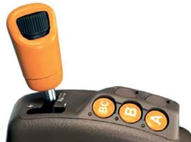
La transmisión DirectDrive es totalmente mecánica pero cambia de forma automática las ocho velocidades de cada uno de sus tres grupos.
