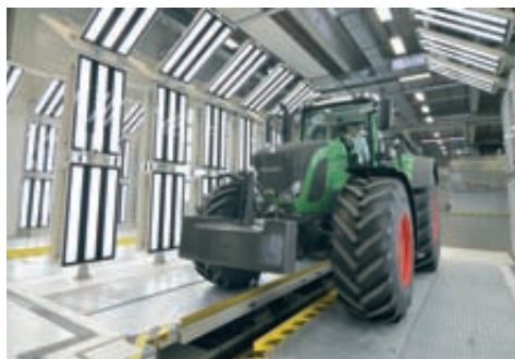
Túnel de luz donde se realizan los controles de calidad de los tractores que salen de la cadena de montaje.
